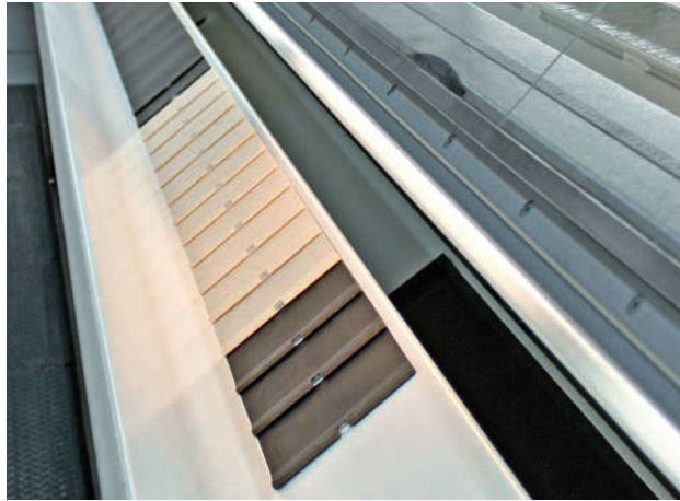
Konfektion der Lamellen auf Maß im Lamellenautomaten.
